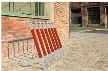
La structure de support en acier galvanisé à chaud peut être traitée avec un revêtement en poudre. Les lattes individuelles du support de vélo sont raccordées au moyen de tubes en acier inoxydable reliés par des raccords vissés dans une unité solide. Il y a des couvertures en caoutchouc sur le dessus des lattes. Quatre plaques en acier inoxydable avec des trous sont soudées au fond pour un ancrage possible à la base.
